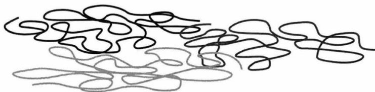
Figura 2. Representación esquemática de una cadena polimérica simple desenrollada tipo filamentosas de una micra cuando se estira y un diámetro de 0,5 nm.
