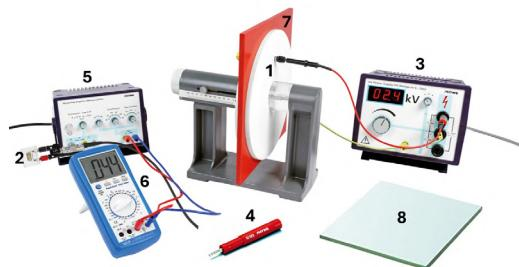
**Figura 1:** Equipo experimental para la medición de la constante dieléctrica del aire, plástico y vidrio.
