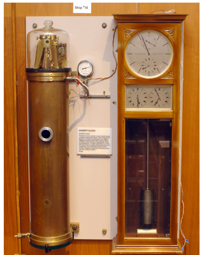
Figura 7. Reloj sincrónico Shortt (1921), compuesto por dos péndulos acoplados: el primario, ubicado en una cámara de vacío (izquierda), y el secundario (derecha), encargado de accionar el mecanismo del reloj. Este diseño permitía aislar el sistema regulador de perturbaciones externas y mejorar la estabilidad del movimiento (National Institute of Standards and Technology, 2023)
