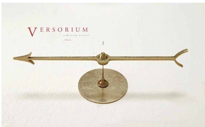
Figura 5: El versorium, creado por William Gilbert en el siglo XVI, es considerado el primer dispositivo diseñado para detectar electricidad estática. Consiste en una aguja metálica muy liviana que puede girarse libremente sobre un eje (similar a una brújula, pero sin imán). Cuando un objeto cargado eléctricamente se aproxima, la aguja gira y apunta hacia él, debido a la inducción electrostática. (Beauty of Science, s. f.).
