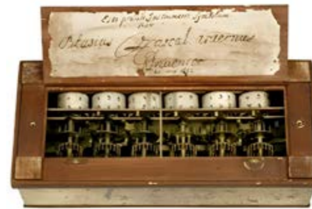
Figura 2: "Pascalina", la primera calculadora mecánica inventada por Blaise Pascal entre 1642 y 1644 para realizar sumas y restas de manera automática (Fenicia BCN, 2020). Era una pequeña caja que disponía de ruedas dentadas alineadas de derecha a izquierda, representando las unidades, decenas, centenas, etc. Cuando una rueda completaba una vuelta sobre su eje, a través de un sistema de transmisión, desplazaba una posición a la rueda siguiente (acarreo de la suma). Para la resta, funcionaba de manera inversa: se giraba la rueda hacia atrás (mecanismo de préstamo) (UMA Divulga, s.f.).
