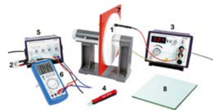
Figura 2: Montaje del equipo experimental para la medición de la constante dieléctrica del aire, plástico y vidrio. Se indican los principales componentes del sistema: (1) Capacitor de placas paralelas, (2) capacitor de referencia, (3) fuente de alto voltaje, (4) Resistencia de 10 MΩ, (5) amplificador universal de medición, (6) multímetro, (7) placa de plástico y (8) placa de vidrio (PHYWE, 2025).
