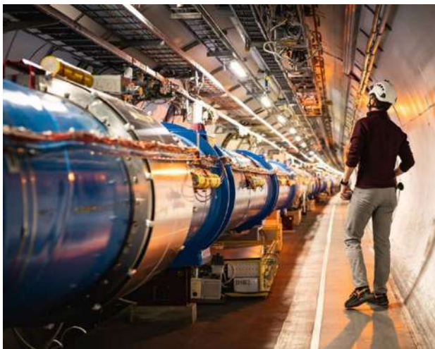
Figura 2. En este tramo del anillo subterráneo de 27 kilómetros del LHC, se pueden observar los tubos por donde circulan los haces de partículas subatómicas a velocidades cercanas a la luz (LHC Deutschland, s. f.).
