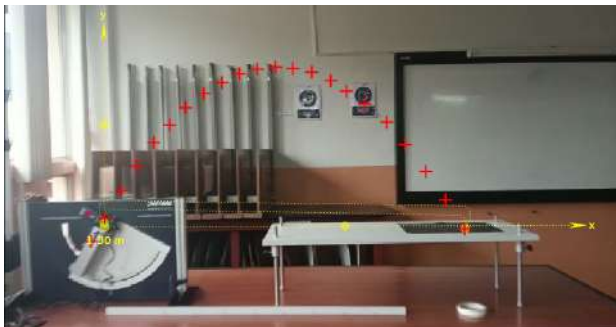
Figura 3. Trayectoria experimental del movimiento parabólico de un cuerpo de prueba obtenido mediante el software Pasco Capstone.
